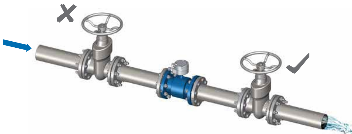
Fig. 22 Posición de válvulas de paso directo
