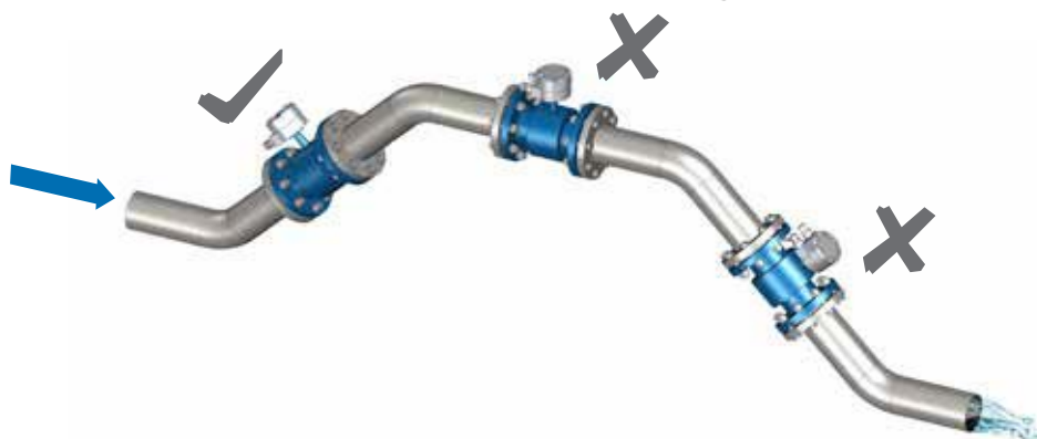
Fig. 21 Posición correcta (SX) y erróneas (centro y DX)
