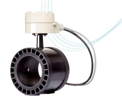
La velocidad máxima recomendada, en aplicaciones normales, es de aproximadamente 2÷3 m/seq. Cabe mencionar que el caudal máximo puede seleccionarse en el campo por medio del teclado del convertidor. El valor máximo que se puede seleccionar es el que corresponde a una velocidad de 10 m/seg.
