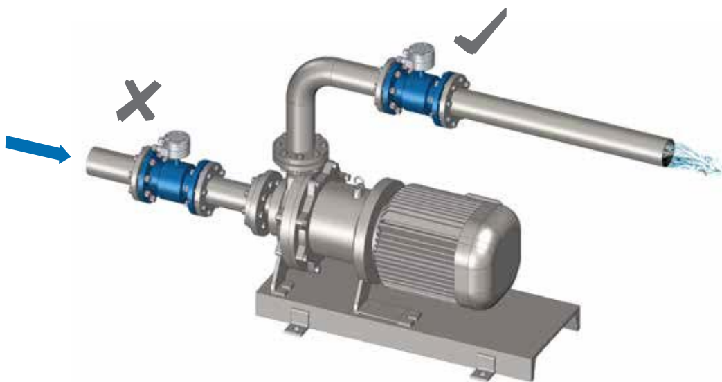
Fig. 23 Evitar presiones negativas
