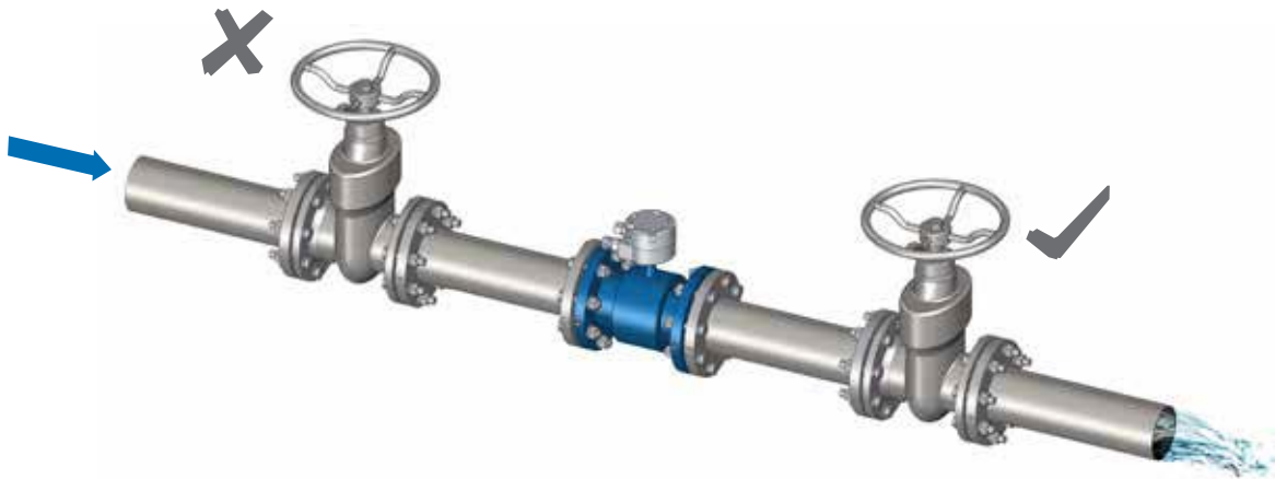
Fig. 22 Posición de válvulas de paso directo
